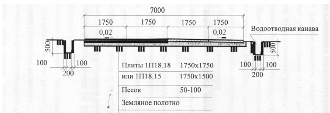
Рис. П.4.5. Тип 5. Двускатная дорога из сборных железобетонных плит шириной 7 м из плит 1750 × 1750
